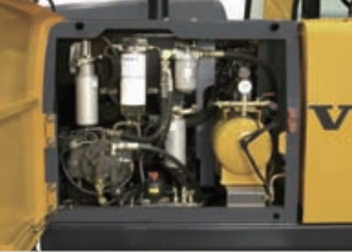
• 易于检修液压泵滤清器。
